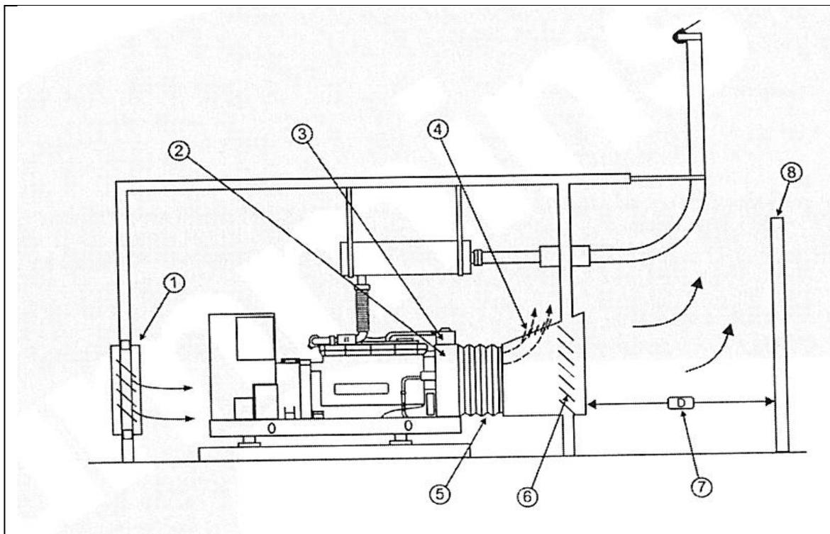
Рис. 11 – Типовая компоновка сборочного узла радиатора
