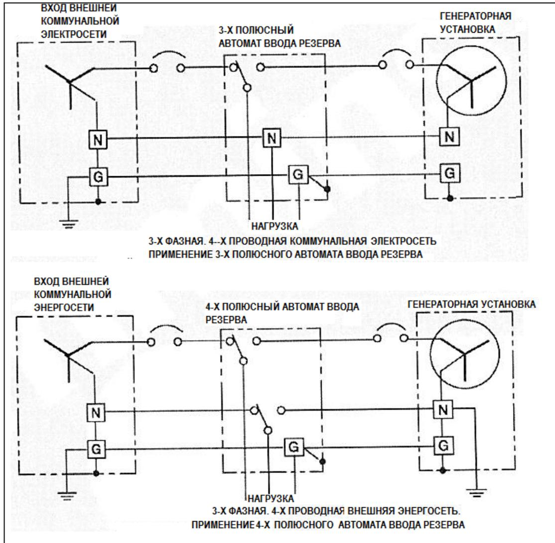
Рис. 15 – Однолинейные схемы типовых систем заземления
